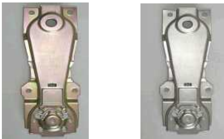
Bild 5. Chromitiertes (links) und mit ein mit organischer Schutzschicht (SurTec 555, rechts) versehenes Bauteil
