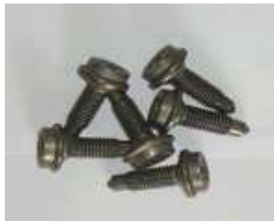
Bild 6. Zn/Fe chromitierte mit und ohne Deltacoll (Schwarz) beschichtete Schrauben
