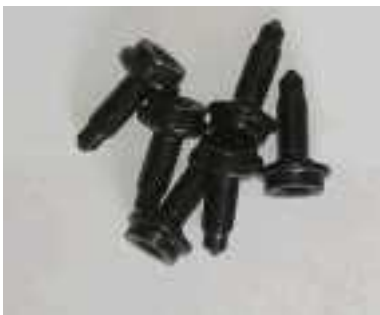
Bild 6. Zn/Fe chromitierte mit und ohne Deltacoll (Schwarz) beschichtete Schrauben
