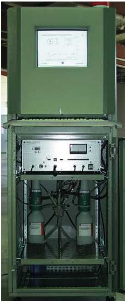
Bild 1. Der Zink-Operator für die elektrochemische Regelung der cyanidfreien alkalischen Verzinkung
