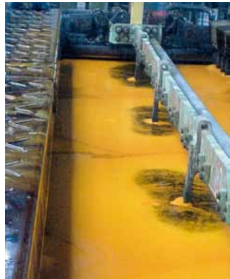
Abb. 7: Das Netzmittel reinigt passive Anoden und bildet einen dunklen Schaum aus, der zu Beschichtungsfehlern führen kann
