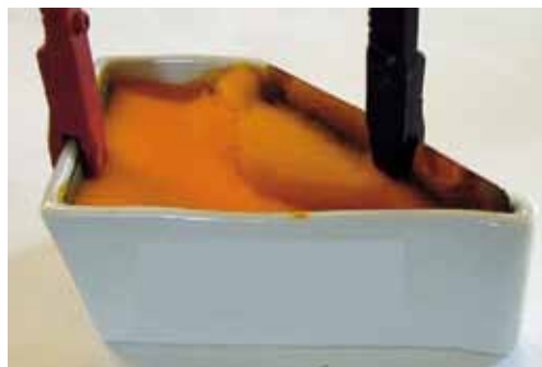
Abb. 2: PFOS-freies Netzmittel nach Zugabe in den Glanzchromelektrolyten SurTec 871
