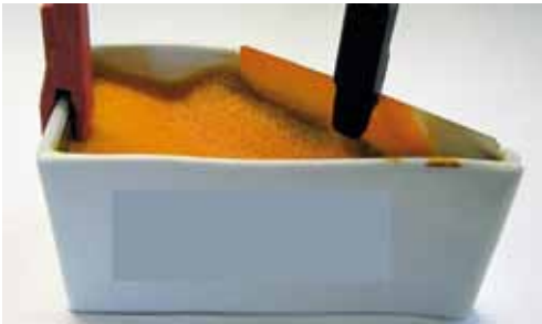
Abb. 5: PFOS-haltiges Netzmittel nach 168 Stunden im Glanzchromelektrolyten SurTec 871
