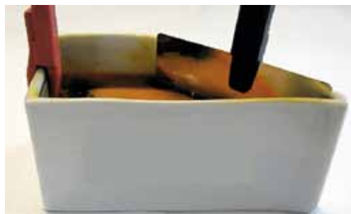
Abb. 3: PFOS-freies Netzmittel nach 168 Stunden im Glanzchromelektrolyten SurTec 871
