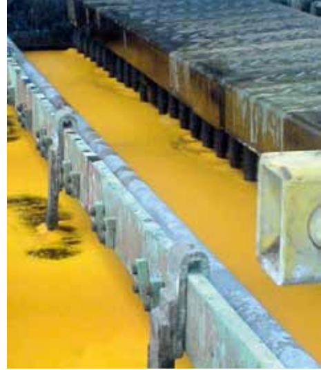
Abb. 6: Einsatz des PFOS-freien Netzmittels im Glanzchromelektrolyt SurTec 871
