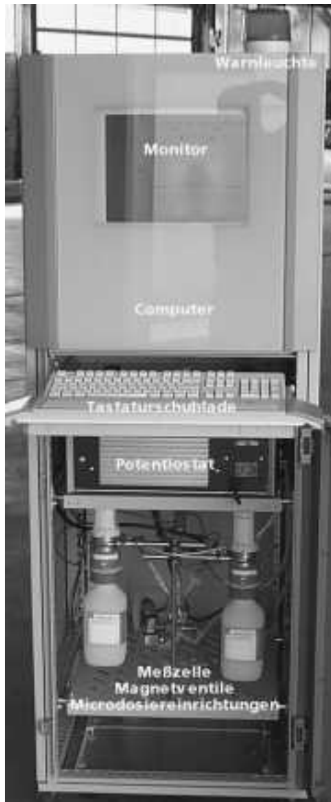
Abb. 4: Der Zink-Operator Elektrochemische automatische Prozeßregelung für hierzu geeignete cyanidfreie alkalische Zinkelektrolyte
