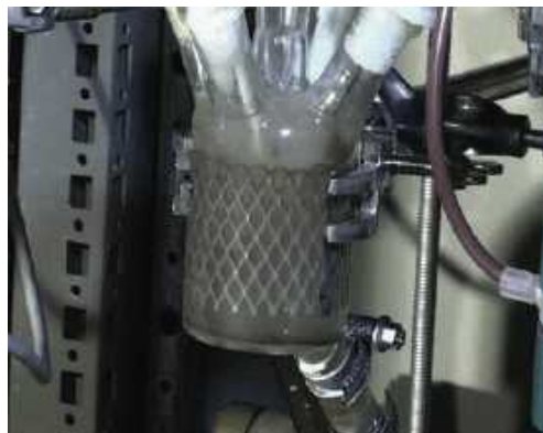
Abb. 5: Die Messzelle des ZinkOperators ; Zinkelektrolyte sind nicht immer eine wasserklare Lösung – Wartung ist von Zeit zu Zeit nötig, um die Funktionsfähigkeit aufrechtzuerhalten
