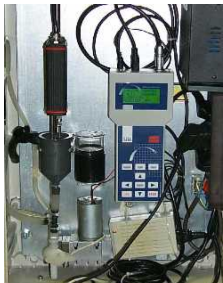
Abb.: Meßstandprototyp mit Blasendrucktensiometer SITA F10 und Meßzelle für Bypass-Betrieb
